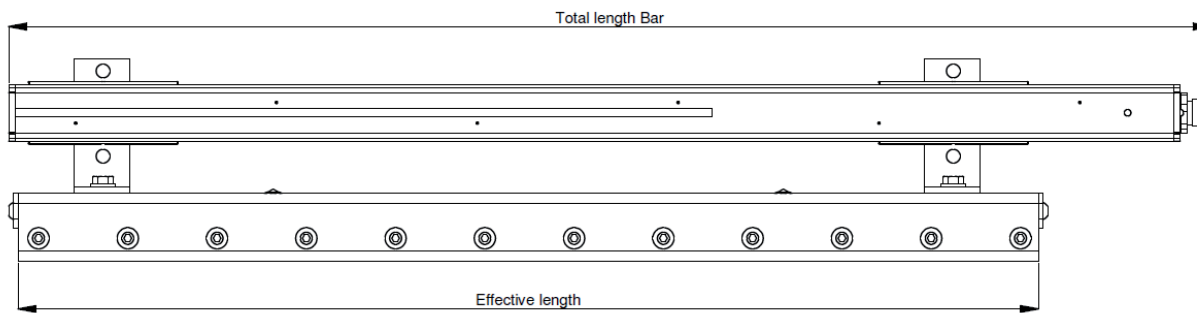
Technische tekening Performax IQ Easy met luchtmes
