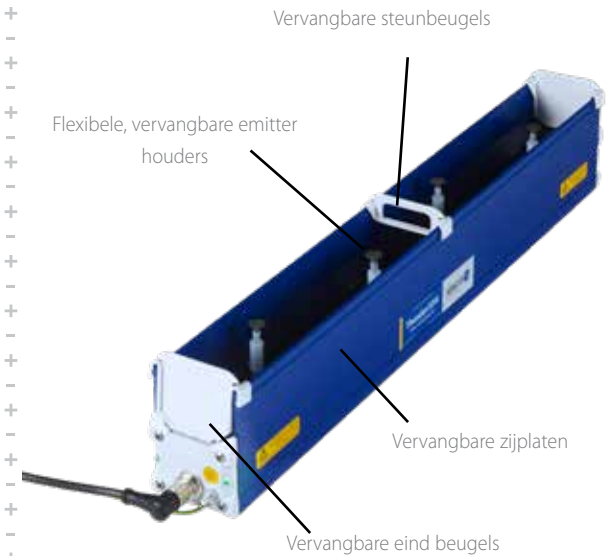
ThunderION 2.0 zonder steun- en eind beugels om makkelijk schoon te maken
